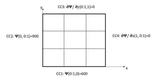
Questão 5: Dada a configuração discretizada de um problema de condução de calor unidimensional estacionária de uma barra de material com propriedades constantes, conforme figura abaixo, indicando as incógnitas e condições de contornos prescritas obedecendo a equação ( $\nabla^2 T=0$ ).
