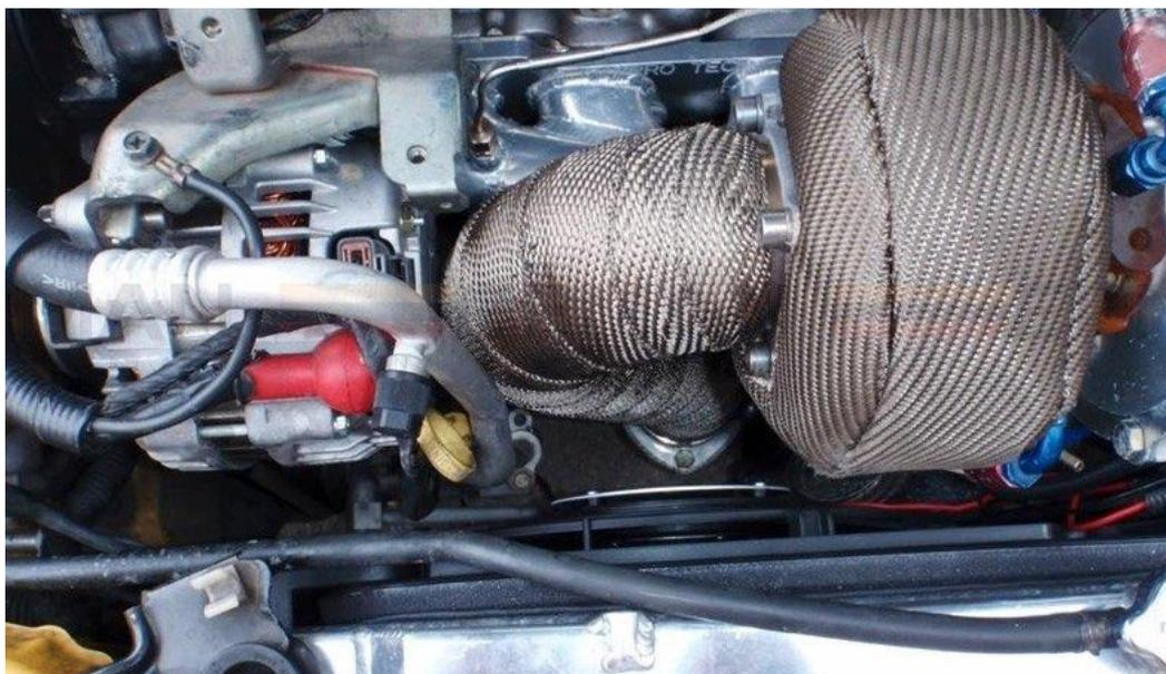
**Figura 31 - Turbina com capa de isolamento térmico.**
