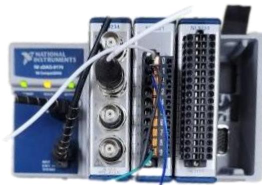
**Figura 34 – Módulos da National Instruments utilizados nos experimentos montados no chassi.
