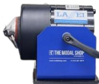
**Figura 35 - Shaker Model 2025E-HF utilizado no experimento acelerado.
