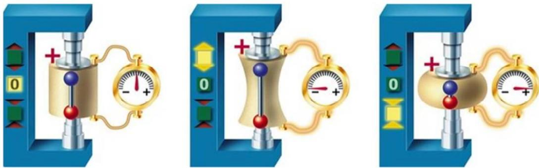
**Figura 5 – Representação do efeito piezoelétrico direto, no qual o sentido da polarização depende do tipo de esforço aplicado.**
