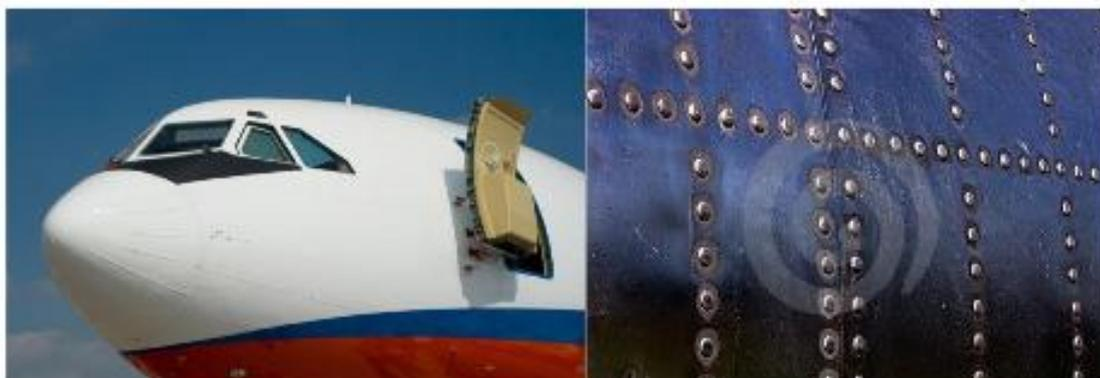
Figura 6 - Comparação de uma superfície rebitada com juntas unidas com adesivos
