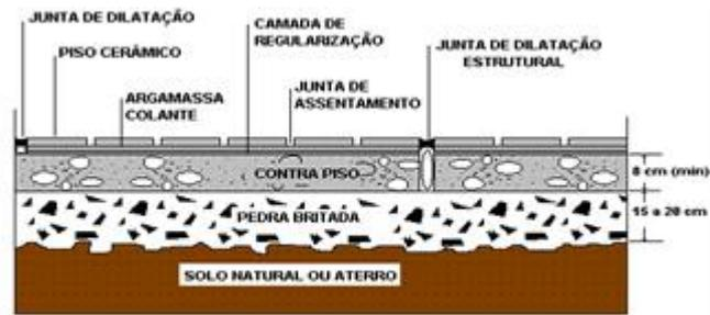
Figura 36: Esquemática da estrutura de uma junta de dilatação
