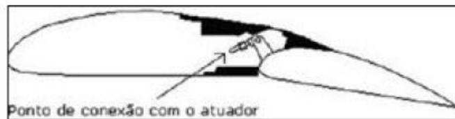
Figura 18: Modelo básico de uma asa de avião com flap (ASUNDI,1996)[75].
