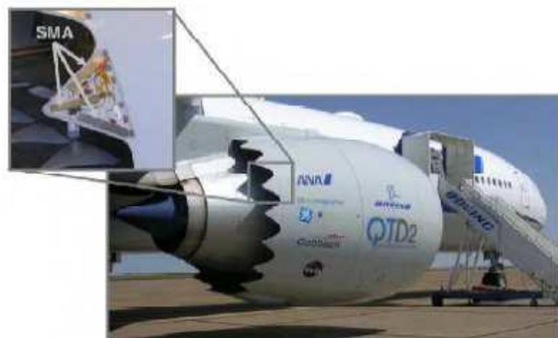
Figura 19 – Avião da Boeing com turbina de geometria variável do elemento de descarga de gases (MABE et al, 2006)[38].
