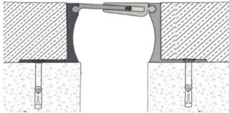
FIGURA 40: Dilatação da Junta.
